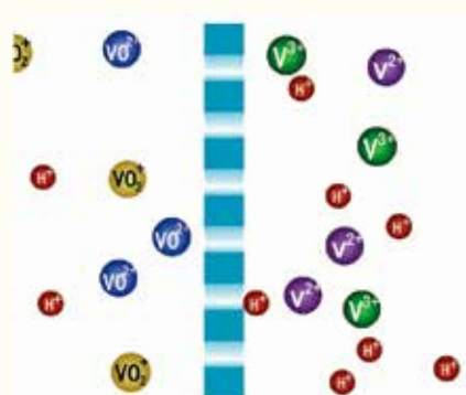
离子传导膜离子筛分传导机理 Ions sieve-conducting mechanism
